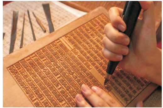
Şekil-12 : Tek parçalı kalıbın hazırlanması
